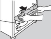
取り付けるときは、圧縮機上部のプッシュに蒸発皿取手部のボスを差し込み、蒸発皿の取手部分が冷凍庫本体に当たるまで押し込んでください。
