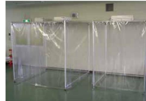
フレームにアルミを使用することで、全体を軽量化。そのため、大規模な設置工場の必要がなく、約60分程度で簡単に組み立てられます。天井部に取り付けるファンフィルタユニットは、100Vコンセントに対応しています。
