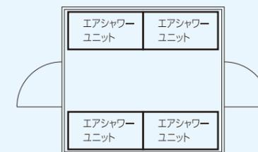
間口、高さともサイズを確保したエアシャワーです。大型機材や大量の原材料をクリーンルーム内へ搬入・搬出する現場での利用に適しています。
